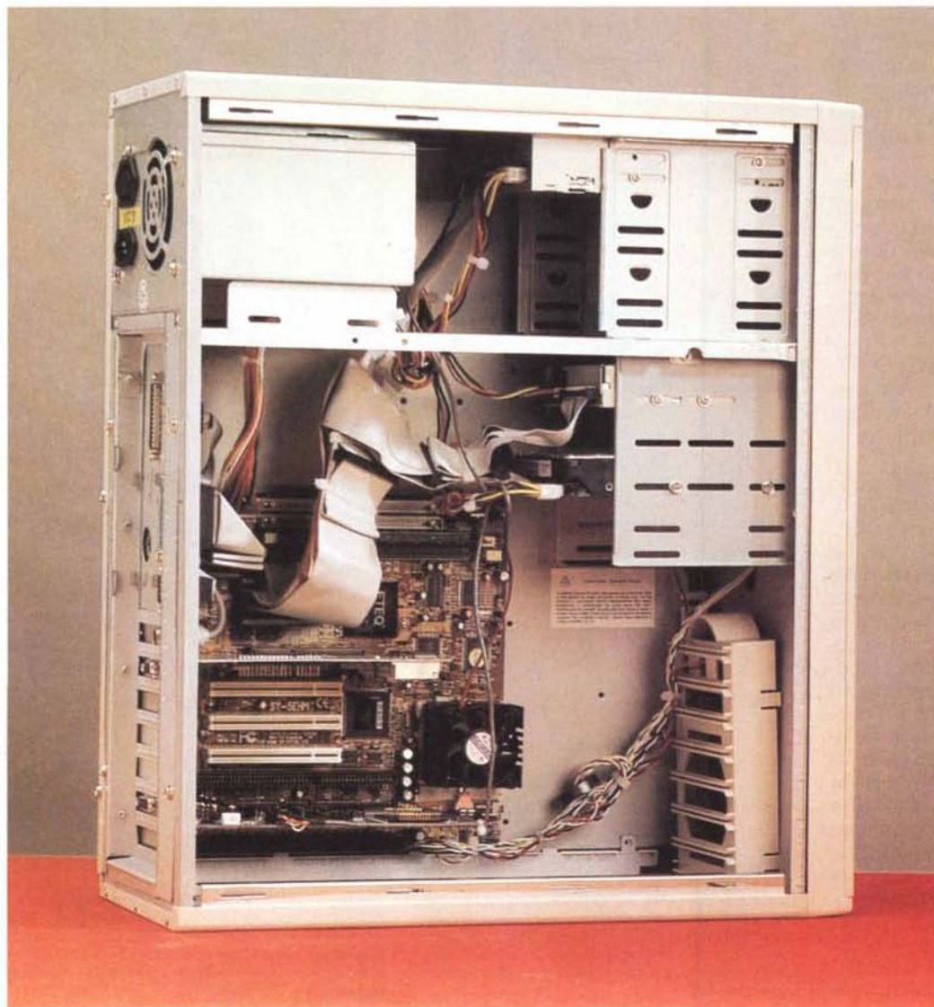
L'interno sembra vuoto soprattutto per le dimensioni della scheda madre. Lo spazio a disposizione in un cabinet è sempre un vantaggio, sia per la possibilità di installare tutto quello che si vuole, sia dal punto di vista termico, ovvero del circolo dell'aria e della temperatura di funzionamento.
